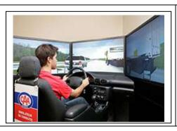
En plus des trois écrans géants procurant au conducteur une vision à 180<sup>0</sup>, les composantes du simulateur de conduite imitent celles d'une vraie voiture :
